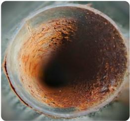
Das in geschlossenen Systemen enthaltene Kühlwasser wird nicht aktiv verdunstet. Es wirkt lediglich zur Wärmeübertragung. Üblicherweise wird enthärtetes Wasser dafür verwendet, welches zwar keine Kalk- oder Mineralablagerungen verursacht, dafür im Gegenzug aber sehr **korrosiv** ist. Konditionierungsmittel für geschlossene Kühlkreisläufe stellen deshalb zum Schutz vor Korrosion besondere Ansprüche an **Korrosionsinhibitoren**.
