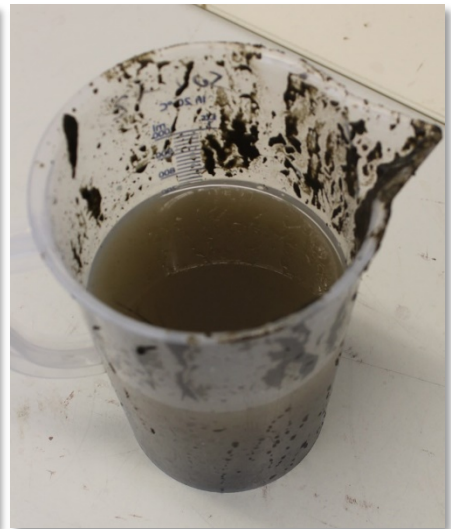
Purgado de capas de biopelícula disueltas tras una desinfección de choque (1 ml Super 25/l de agua) procedente de una tubería de agua.
