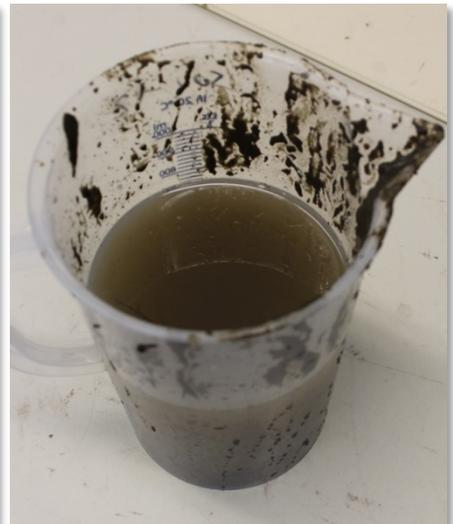
Rinçage d'une conduite d'eau après une désinfection choc (1 ml de Super 25/l d'eau) afin d'en éliminer les lambeaux de dépôts de biofilm.
