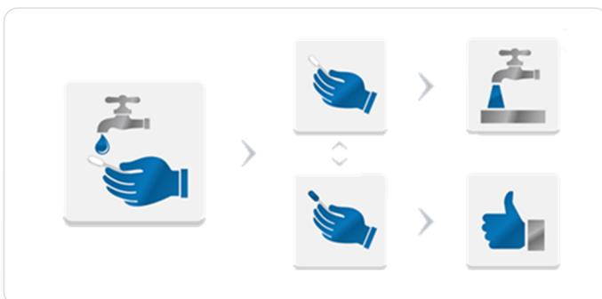
Les bandelettes de mesure Sanostrips 200 permettent de détecter la présence de Sanosil dans l'eau, elles se colorent en bleu en présence de Sanosil S100.
